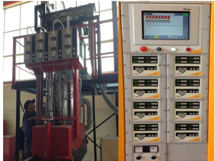
Система нанесения эпоксидного порошка
