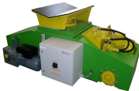
Однопозиционная передаточная тележка
