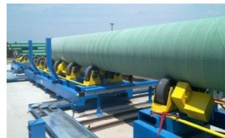
Конвейер линии обдирки
