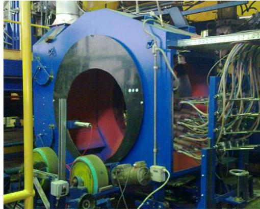
Оборудование нанесения эпоксидного порошка (FBE)
